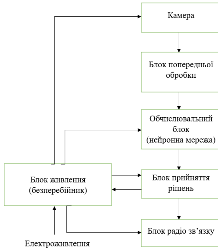
Рисунок 2.3 – Архітектури системи захисту на базі модуля ESP32-S3-CAM.
