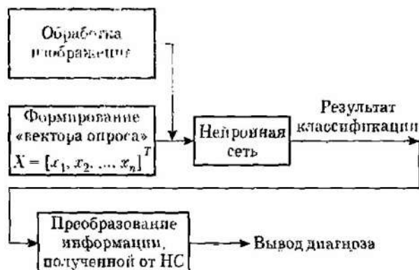
Рис. 4. Схема функционирования нейросетевой экспертной системы
