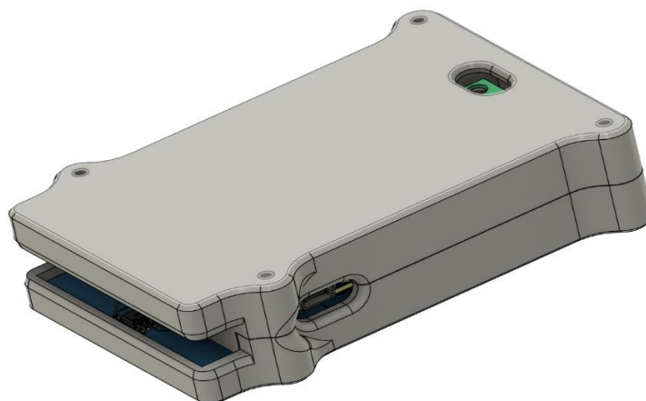
Рис. 2. Корпус фрагменту пристрою для визначення ступеня проникності оптичних середовищ
