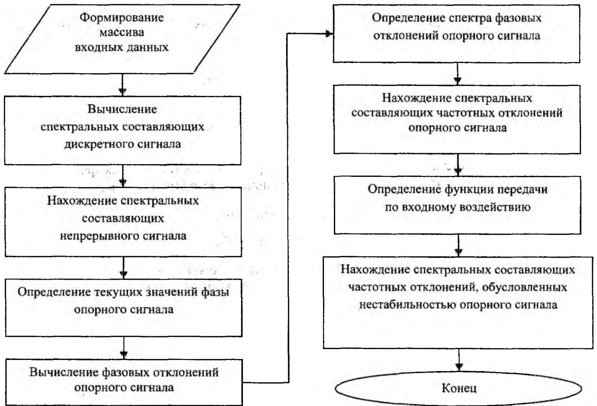
Рис. 3. Блок-схема алгоритма для исследования реакции системы ФАПЧ на входное воздействие
