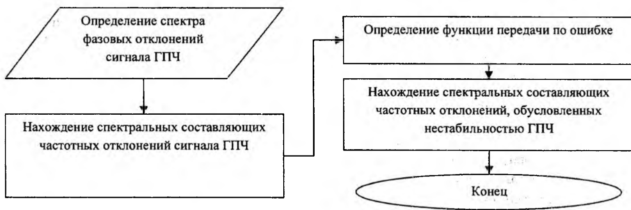
Рис. 4. Блок-схема алгоритма для исследования реакции системы ФАПЧ по ошибке
