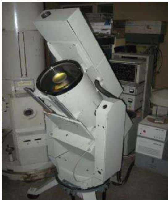
Рисунок 1.9 – Багатохвильовий лідар з раманівськими каналами
