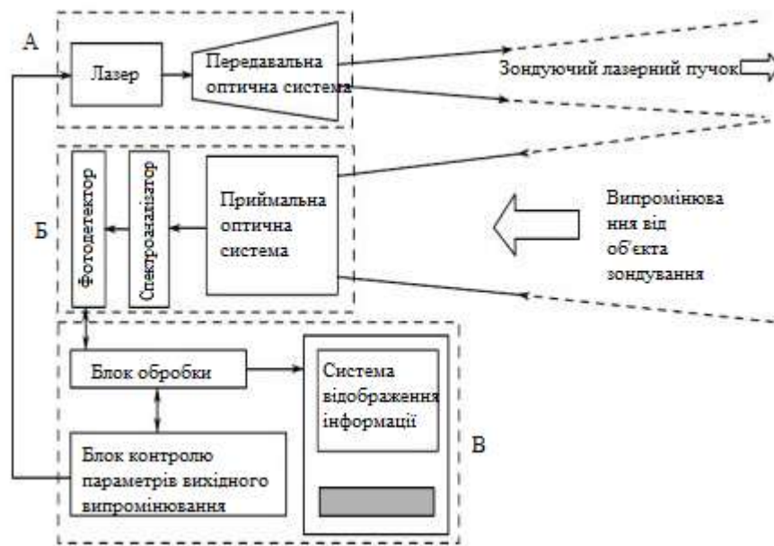
Рисунок 1.3 – Принципова схема лідару: передавальна частина А, приймальна частина Б, система управління В
