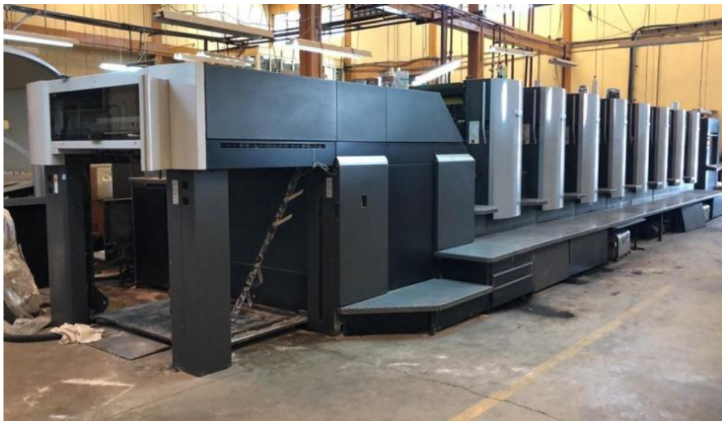
Рисунок 5.1 – Друкарська машина Heidelberg Speedmaster SM 102-8P
