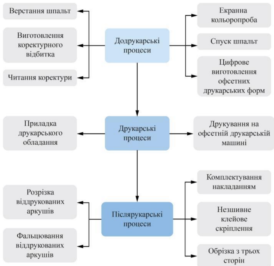
Рисунок 4.1 – Схема технологічного процесу виготовлення книжкового видання
