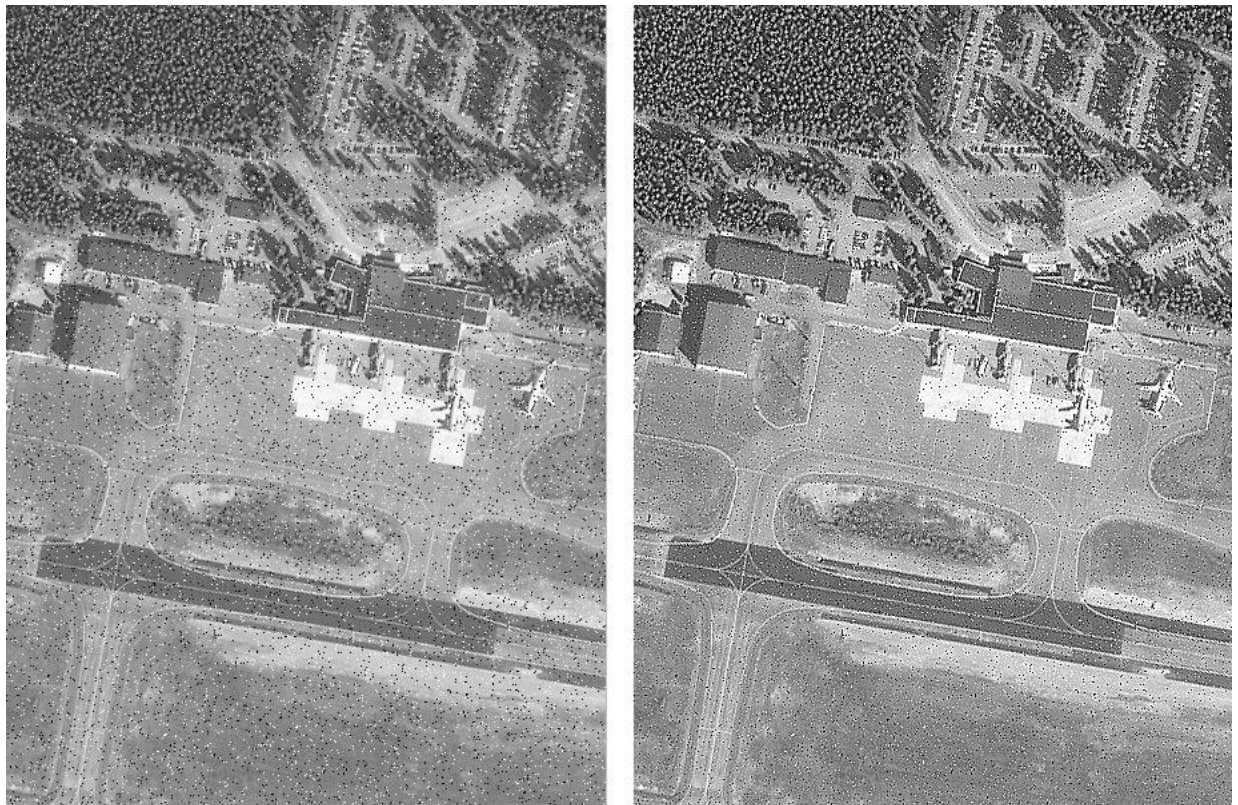
Рисунок 2.15 – Результат застосування сігма-фільтра
