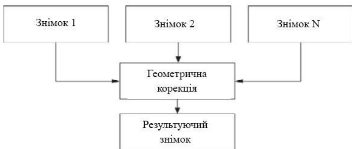
Рисунок 3.1 – Схема накопичення кадрів з геометричною корекцією
