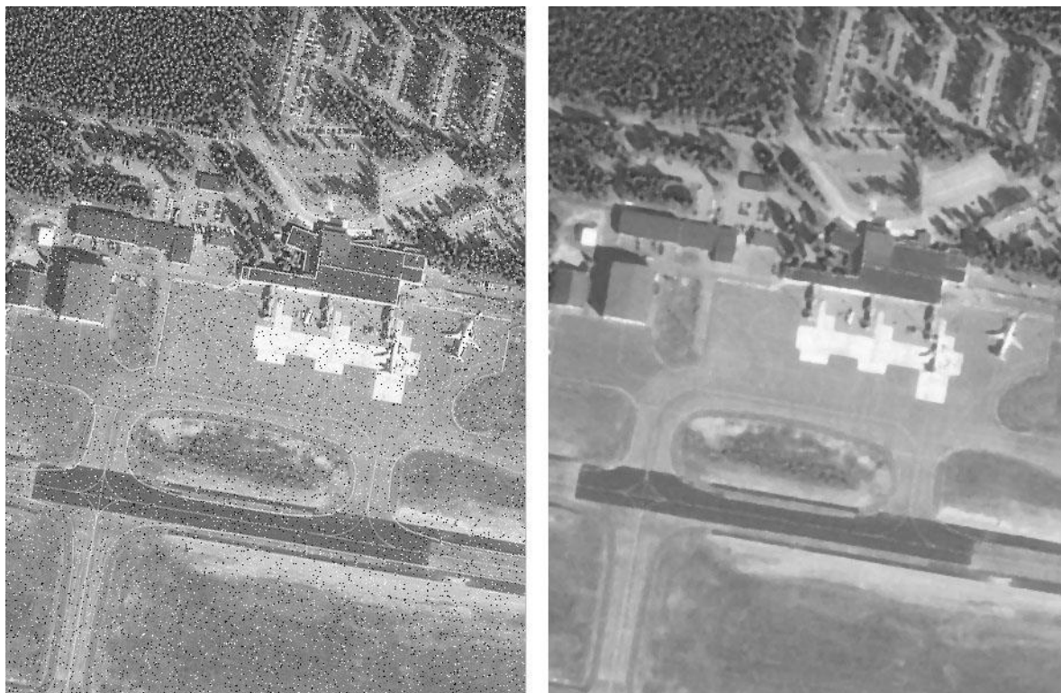
Рисунок 2.13 – Результат застосування медіанного фільтра
