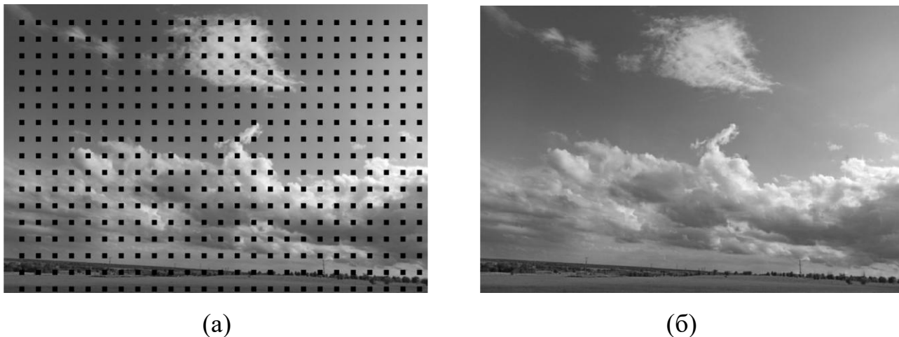
Рисунок 4.4 – Відновлення зображення поверхні (а – пошкоджене зображення на системі вертикальних смуг; б – результат відновлення оператором інтерстріпації)
