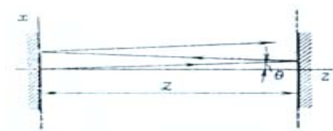
Рисунок 1.1 – Схема інтерферометра Фабрі-Перо
