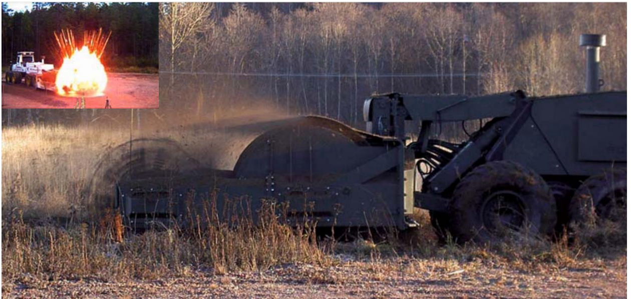
Рисунок 1.6 – DOK-ING очищує місцевість від рослин на головному зображенні та детонує протипіхотну міну на вставному [13]
