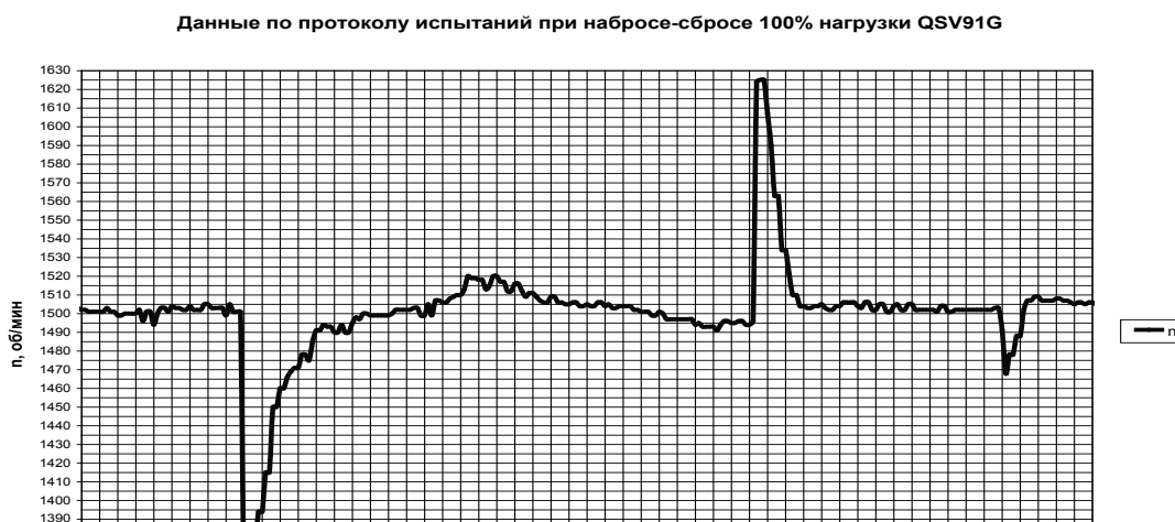
Рис. 15. Переходные процессы ГПЭС на базе QSV91G по протоколу испытаний
