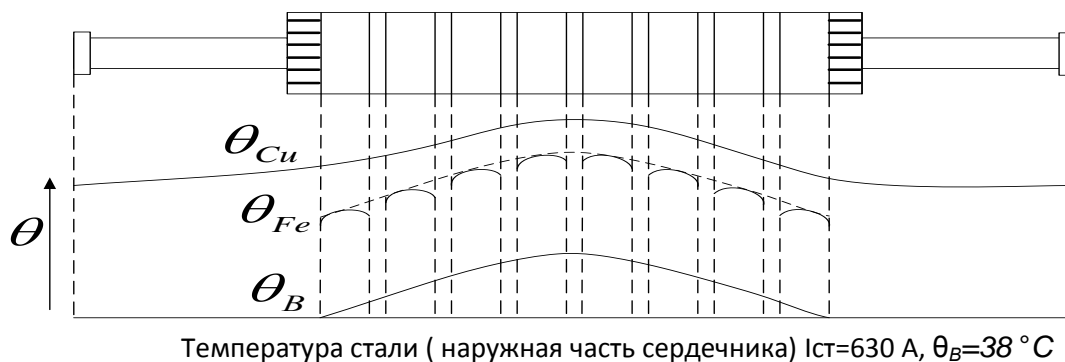
Рис. 5. Графики распределения температуры меди и стали статора электрической машины: \theta_{Cu} - температура меди; \theta_{Fe} - температура стали; \theta_B - температура охлаждающего воздуха. На нижней шкале температуры наружной стороны сердечника статора, полученные с тепловизора, на работающем электродвигателе СТД-12500-2
