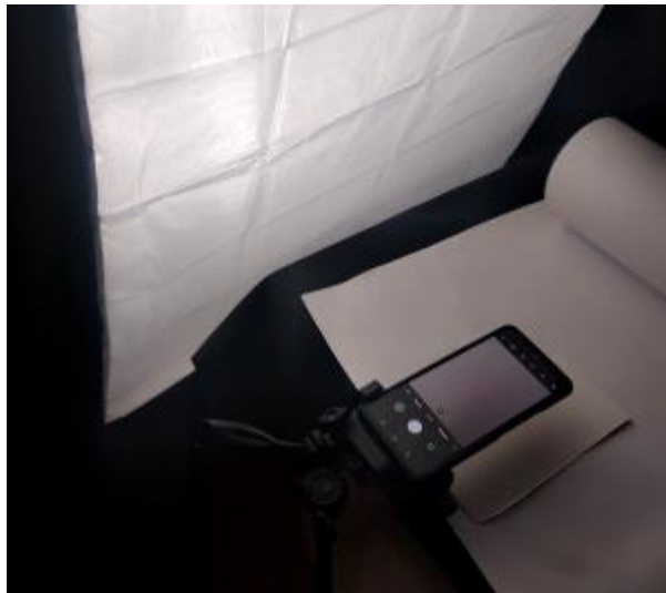
Рисунок 2.12 – Експеримент з визначення відношення сигнал-шум у зображенні
