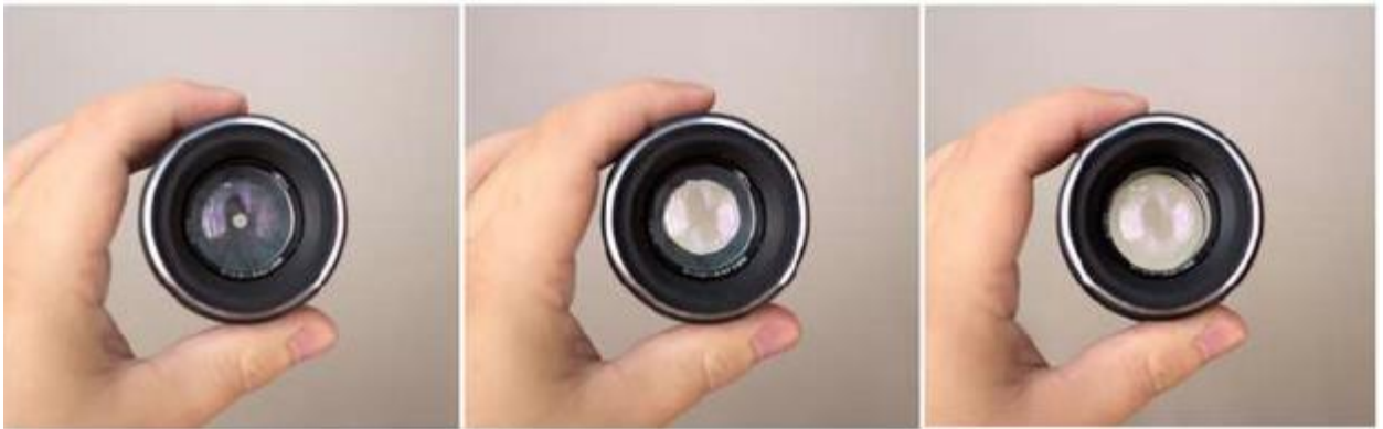
Рисунок 1.5 – Зовнішній вигляд об’єктиву з різною діафрагмою F (а – F = 16 , б – F = 5,6 , в – F = 2,0 )
