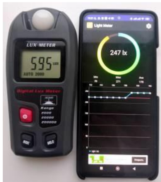
Рисунок 2.10 – Люксметр МТ30 (а) і смартфон Xiaomi Redmi Note 10 Pro (б) в режимі вимірювання освітленості
