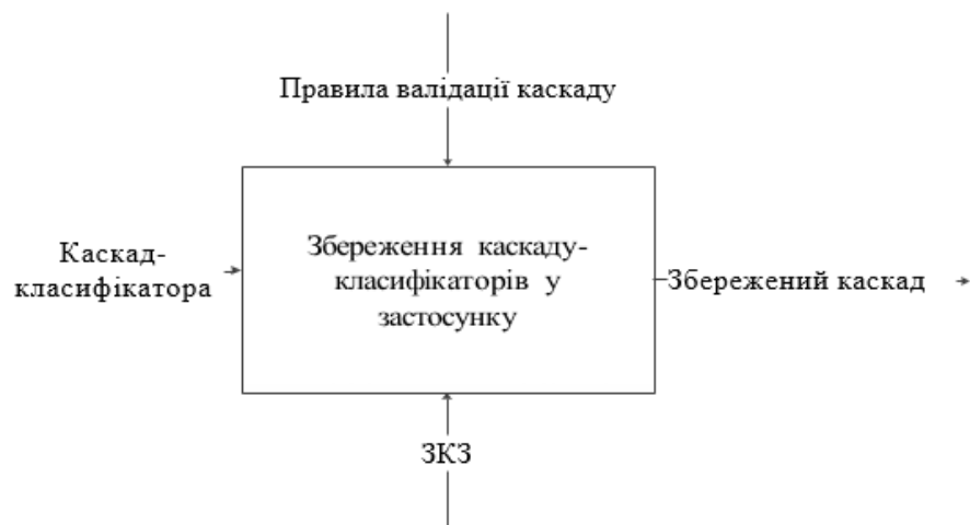
Рисунок 2.2 – IDEF0-діаграма завантаження навченого каскаду-класифікаторів у застосунок
