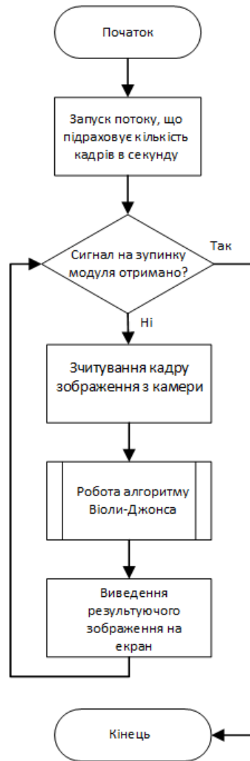
Рисунок 2.5 – Блок-схема узагальненого варіанта однопотокового модуля з розпізнавання об'єкта з відео потоку
