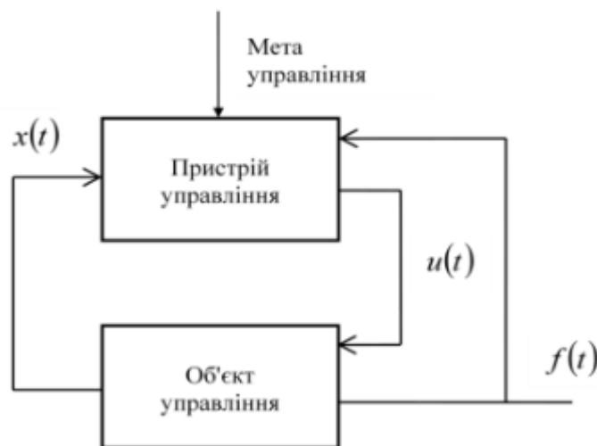
Рисунок 3.1 – Структурна схема системи автоматичного управління [28]
