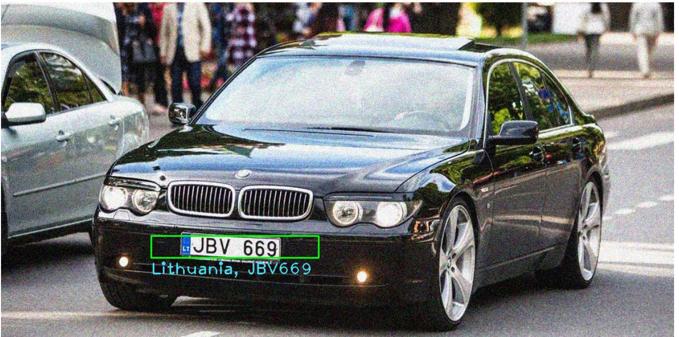
Рисунок 4.10 – Результат розпізнавання країни та номеру на номерному знаку
