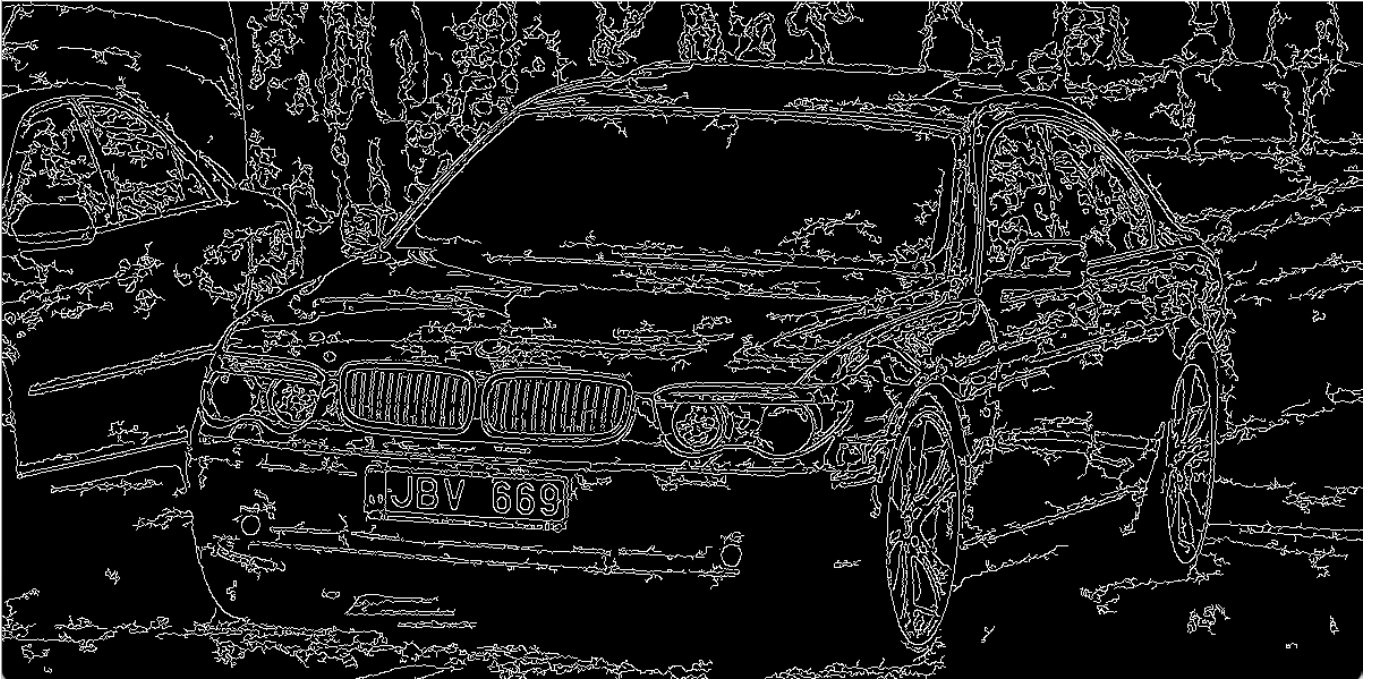
Рисунок 4.5 – Результат накладання фільтру та знаходження країв зображення
