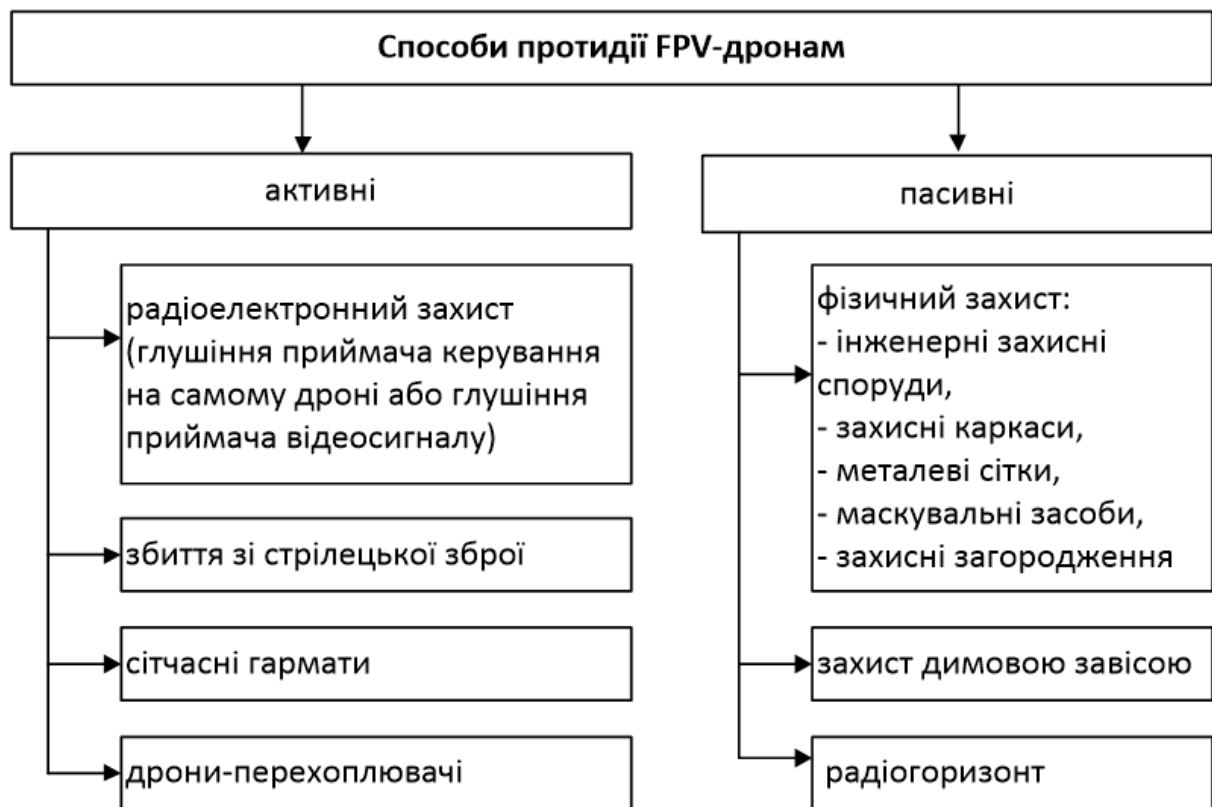
Рисунок 1.9 – Способи протидії ворожим FPV-дронам
