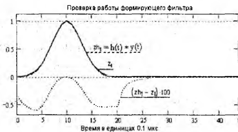
Рис. 8. Сопоставление заданной формы сигнала z(t) и формы сигнала zh(t)
