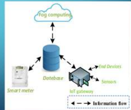
Схема підключення та зв'язку пристроїв Інтернету речей (IoT)
