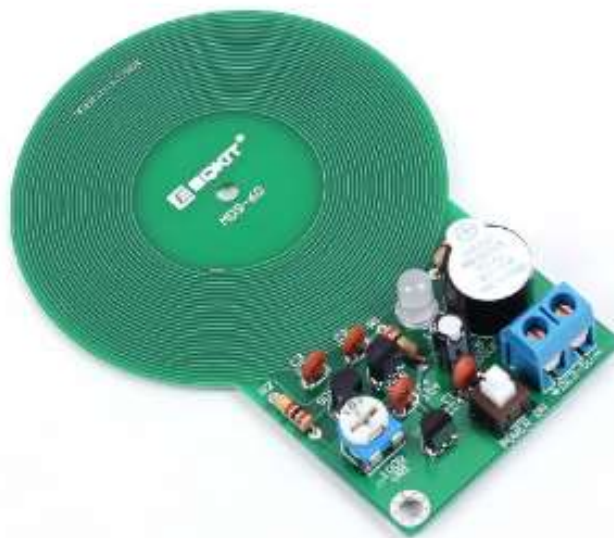
Рисунок 2.17 – Металошукач MDS-60 зібраному стані [38]
