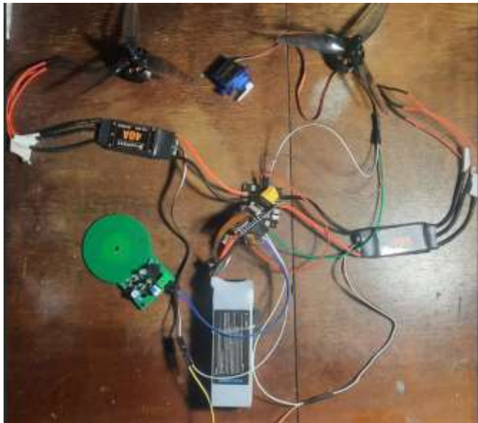
Рисунок 2.19 – Зібрана схема підключення
