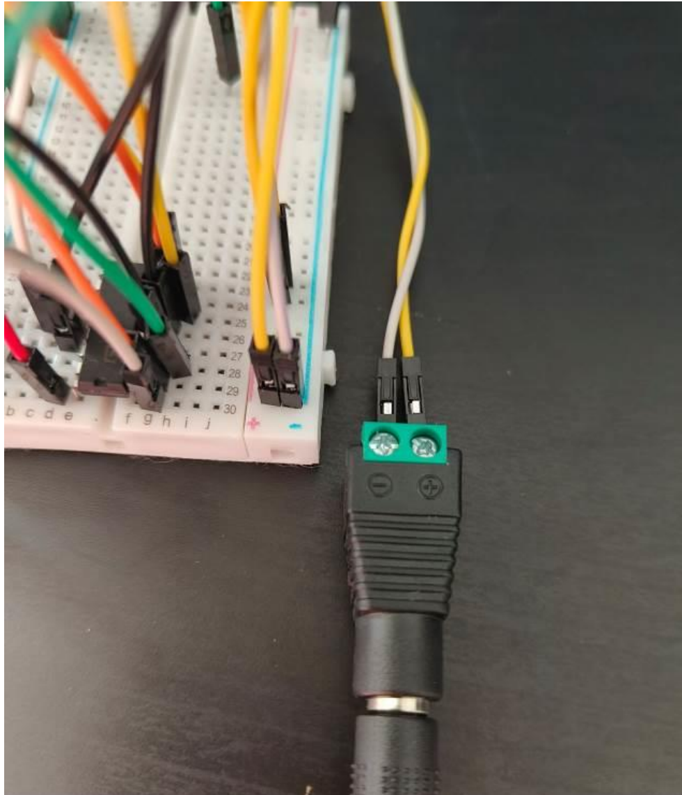
Рисунок 4.9 – Підключення блоку живлення до макету
