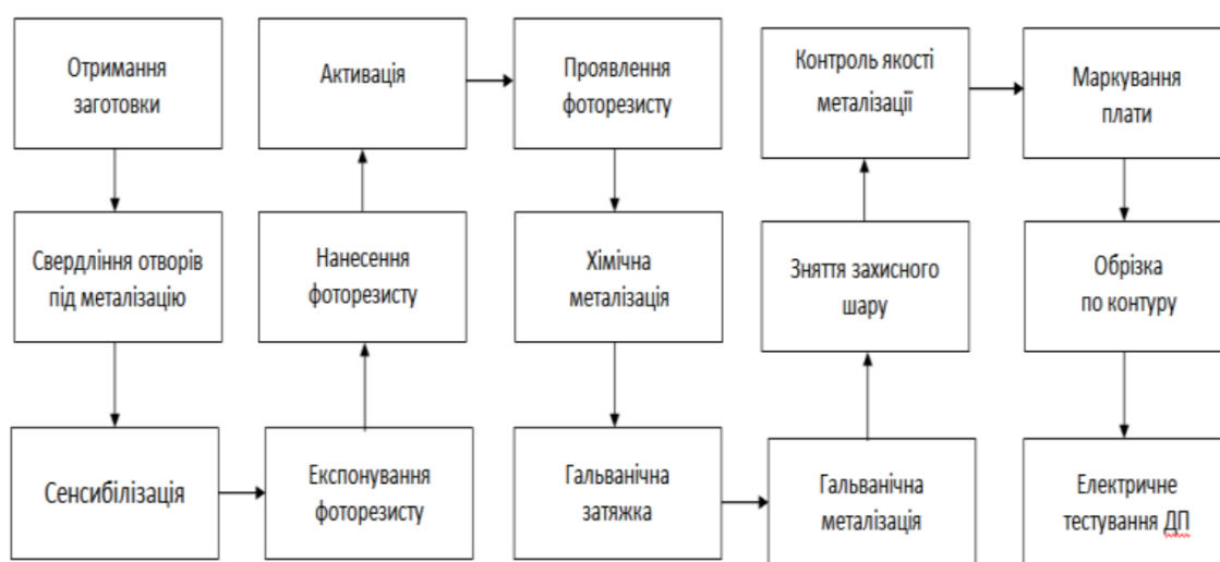
Рисунок 1.2 – Структурна схема ТП виготовлення ДП [7]
