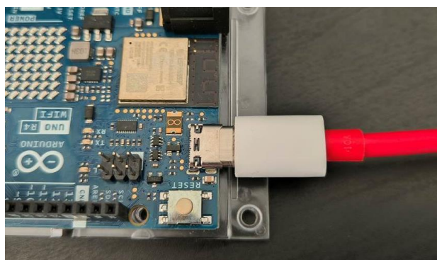
Рисунок 4.8 – Підключення живлення до Arduino
