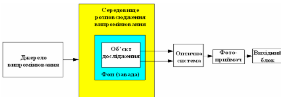
Рисунок 3 – Узагальнена структурна схема оптико-електронної системи
