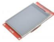
320x240 2.8" TFT LCD ILI9341 + XPT2046 Протокол SPI
