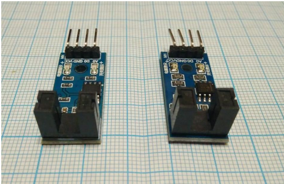
Рисунок 3.4 – Зовнішній вигляд таходатчику, що використовується в конструкції дослідного макету
