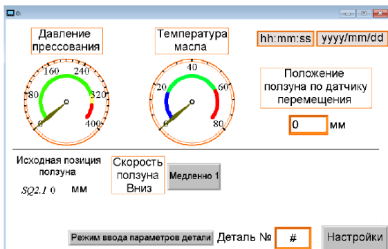
Рис. 8. Конструкция главного окна управления ( Form_{PO}^{master} ) пресом DA2238B
