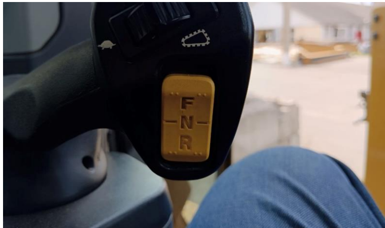
Рисунок 2.4 – Орган управління напрямком руху транспортного засобу
