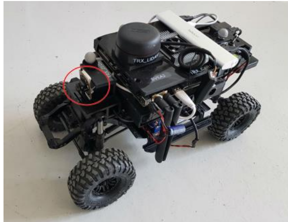
Рисунок 1.5 – Дистанційно керований транспортний засіб з камерою
