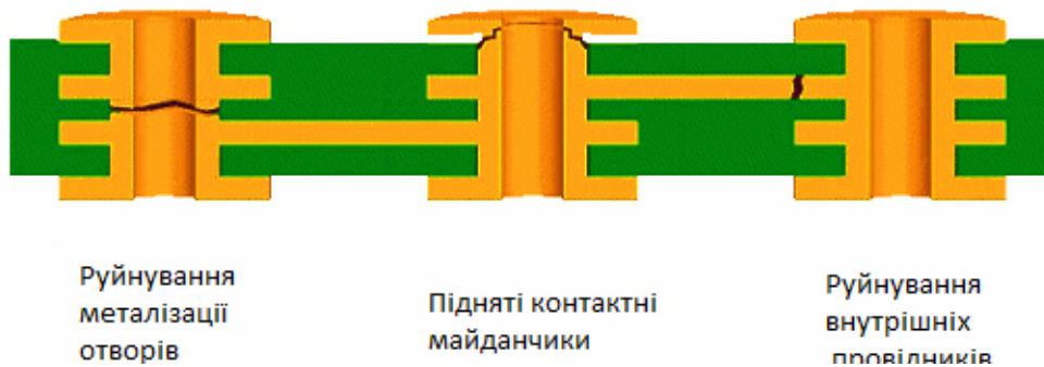
Рисунок 4 – Дефекти, які утворюються через температурний вплив
