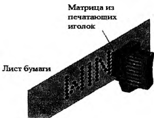
Рис. 5. Принцип работы матричного принтера
