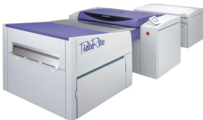
Рисунок 6. 3 – Вигляд Screen PlateRite [7]
