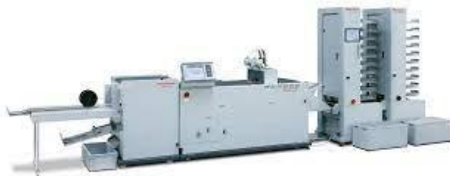
Рисунок 6.5 – Вигляд Horizon SPF-200L у лінію з Horizon VAC [19]
