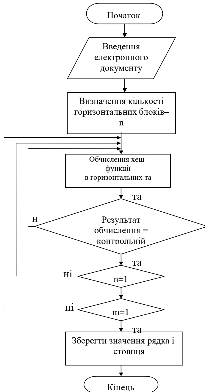
Рисунок 3.8 – Алгоритм виявлення фальсифікованого фрагменту електронного документу методом перехресного хешування
