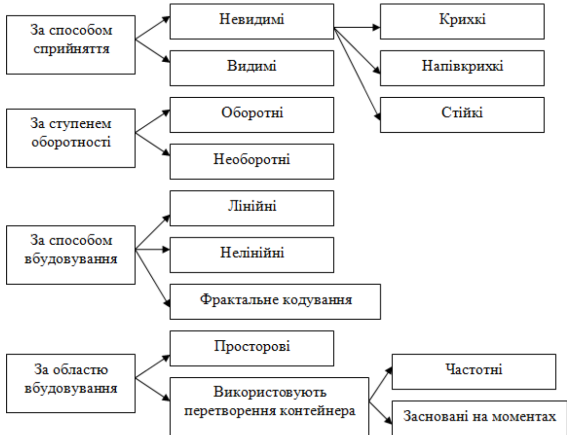
Рисунок 2.7– Класифікація методів накладання цифрового водяного знаку
