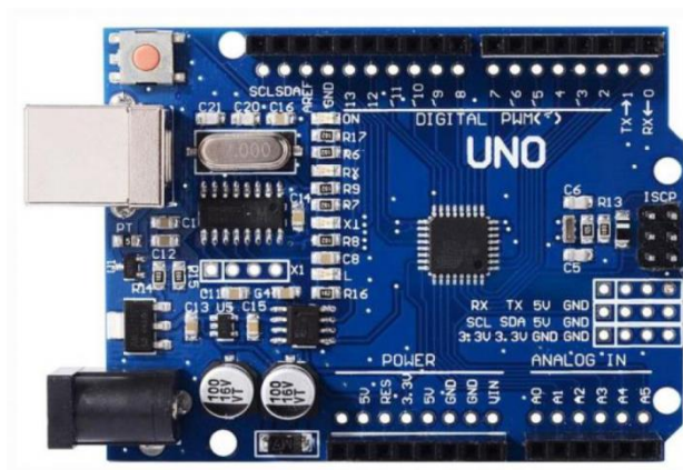
Рисунок 1.7 – Контролер Arduino Uno R3 на основі мікроконтролера ATmega328P
