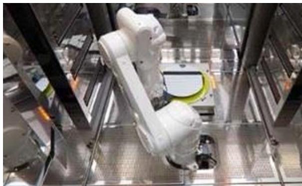
Рисунок 1.9 – Шестикоординатний робот, що обслуговує лінію
