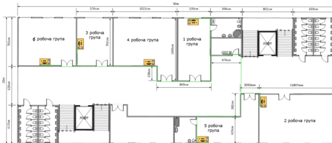
Рис. 1. Схема розведення крученої пари і розташування мережного обладнання та ПК
