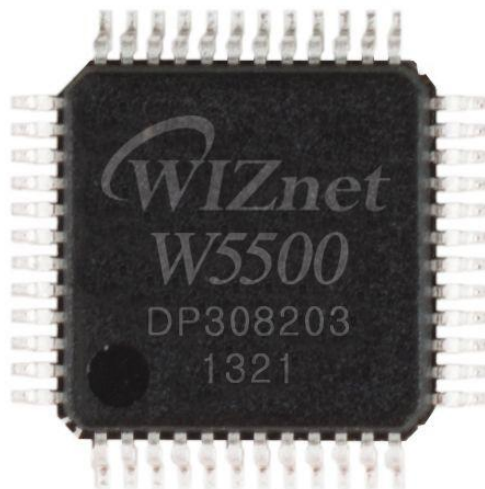
Рисунок 2.4 – Зовнішній вигляд модулю WIZnet W5500
