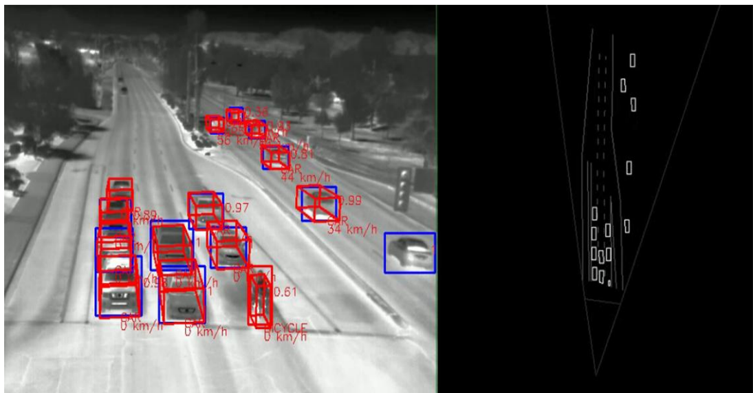
Рисунок 1.5 – Інфрачервоне (теплове) зображення міської дороги з автоматичним виявленням транспортних засобів за допомогою інфрачервоної камери FLIR [11]
