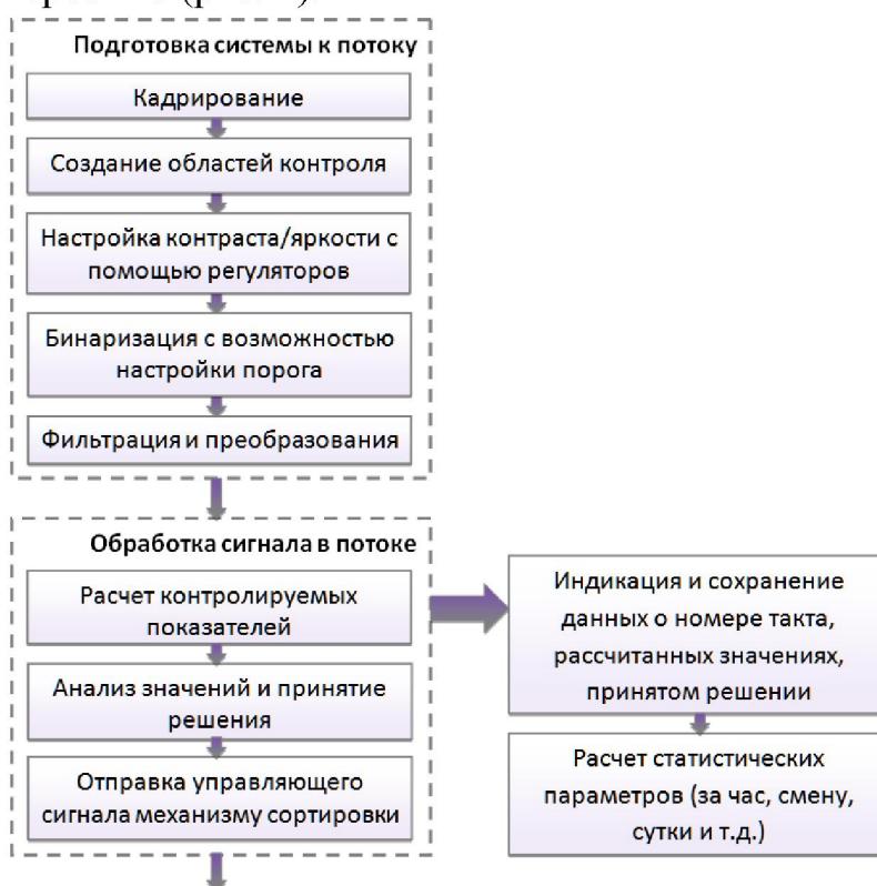
Рисунок 2 – Алгоритм работы системы видеоконтроля
