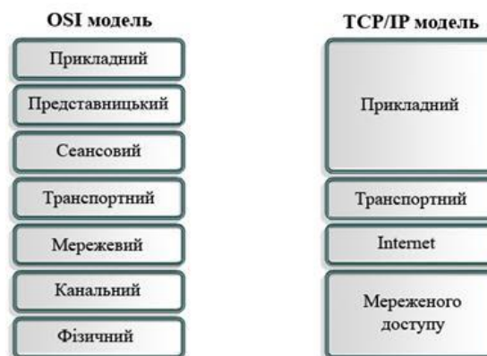
Рисунок 1.2 – Порівняння моделі ISO-OSI та архітектури TCP/IP
