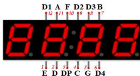
Рисунок 3.13 – Піни 7-сегментного індикатора із загальним катодом
