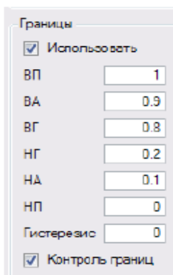
Рисунок 6.62 – Встановлення меж каналу
