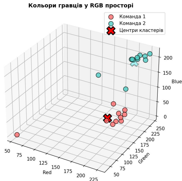
Рисунок 4.8 – Процес глобальної кластеризації кольорів форм методом К-Means
