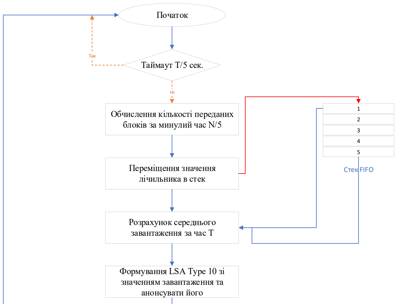
Рисунок 3.2 – Алгоритм розрахунку поточного навантаження уздовж MP-BGP-сесії
