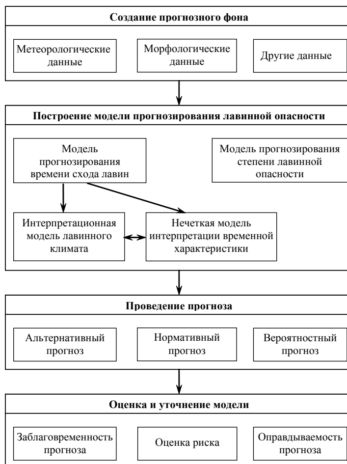
Рис. 2. Этапы функционирования подсистемы прогнозирования
