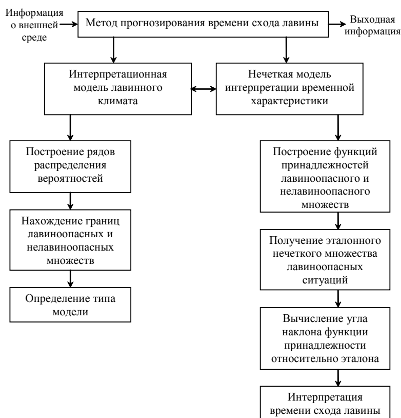
Рис. 3. Многоуровневое построение метода прогнозирования временной характеристики схода лавины
