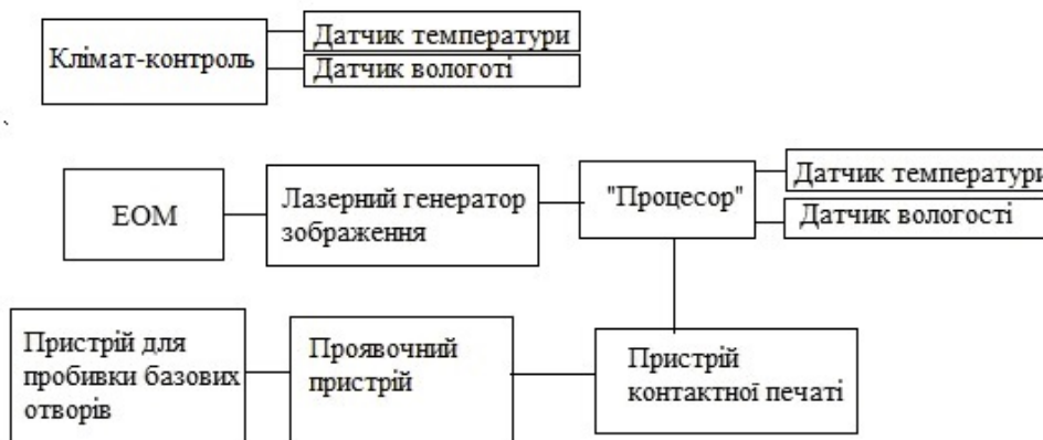
Рисунок 1 – Структурна схема процесу контролю і виготовлення ФШ
