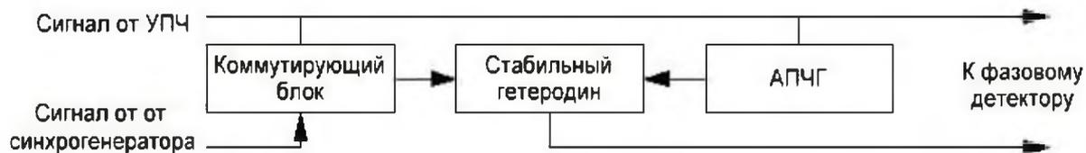
Рисунок 1 - Схема имитационной модели ГЖВ.
