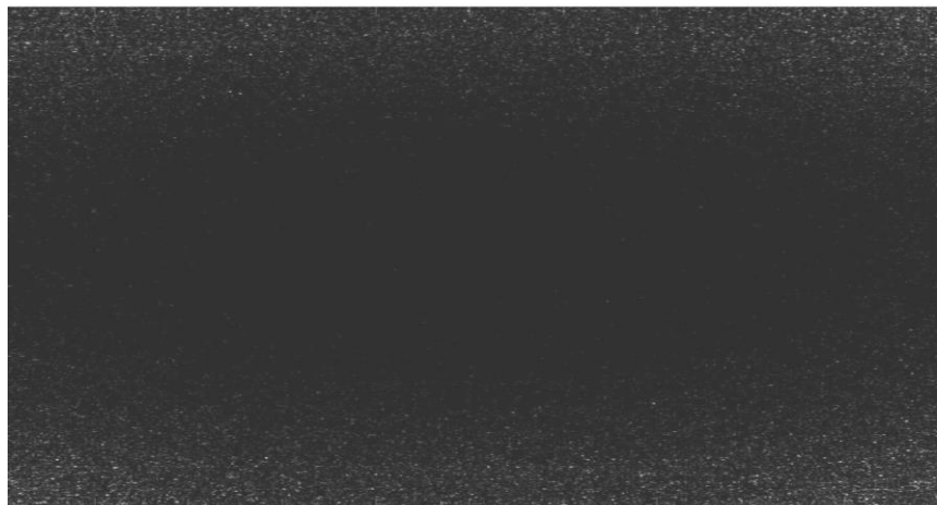
Рисунок 2.9 – Середній темновий кадр матриці та фіксований розподіл шуму (білі точки) камери Xiaomi Redmi 8
