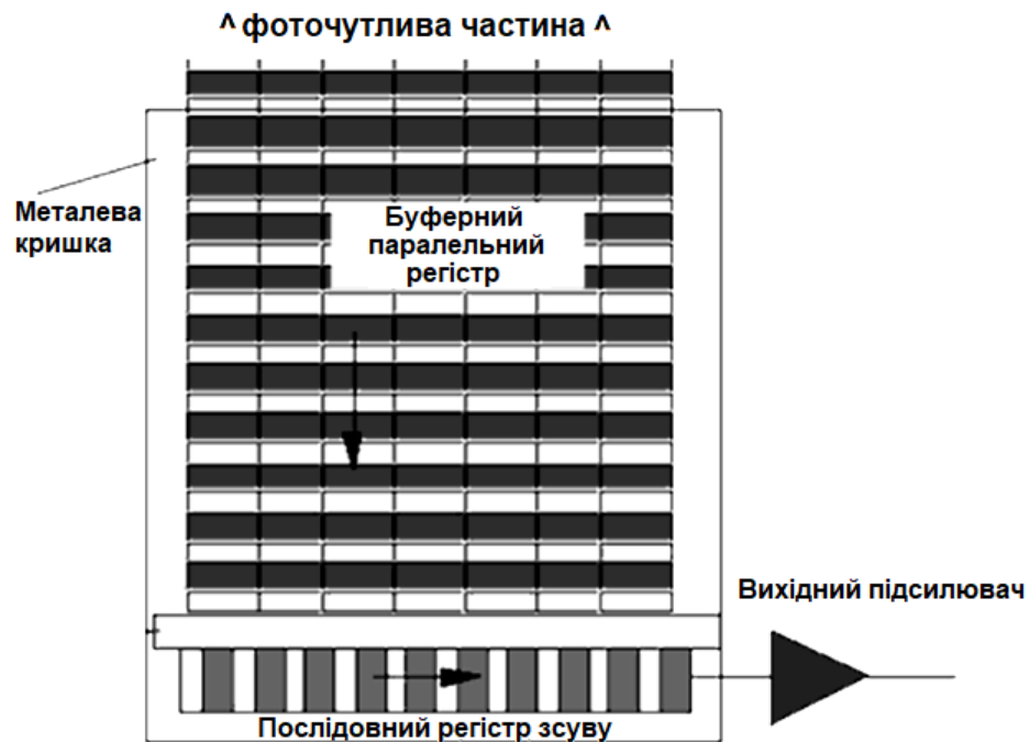
Рисунок 1.8 – ПЗЗ матриця з буферизацією кадру
