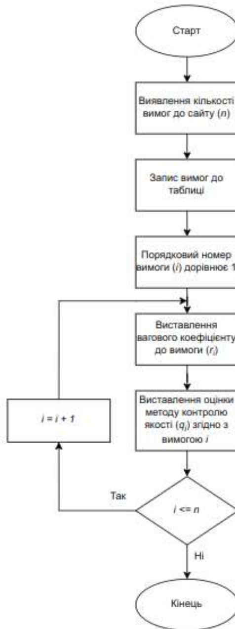
Рисунок 3.3 – Блок-схема заповнення порівняльної таблиці з оцінками кожного методу контролю якості за вказаними вимогами
