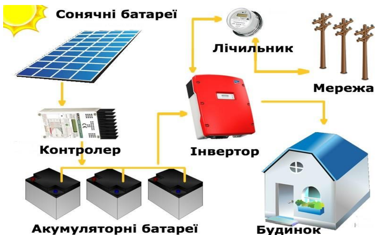
Рисунок. 3.1 – Склад автономної електростанції
