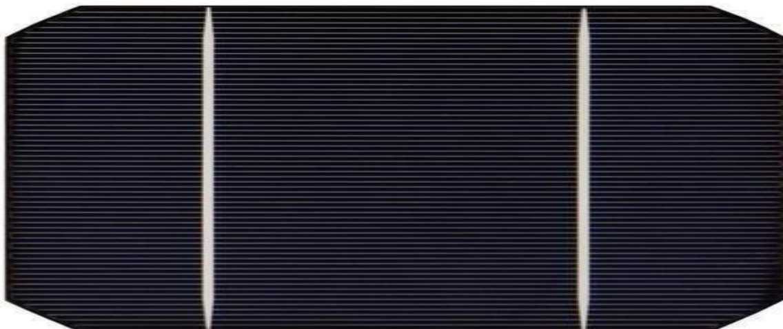
Рисунок 2.1 – Використання монокристалічного кремнію у сонячній батареї
