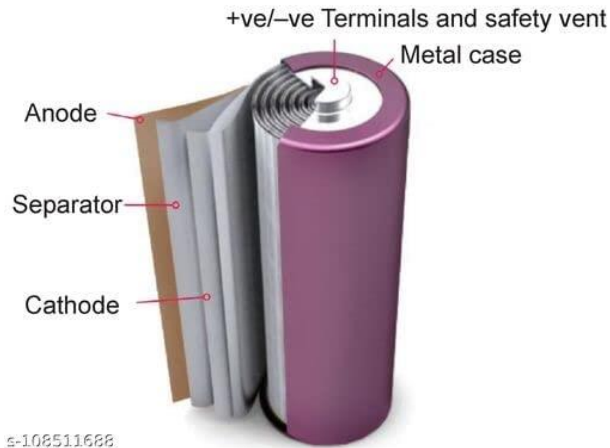
Рисунок 6.1 – Літійовий акумулятор у розрізі
