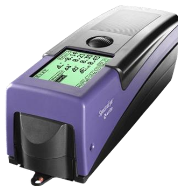
Рисунок 2.1 – Спектроденситометр GretagMacbeth SpectroEye (ТОВ «Лазерфлекс»)
