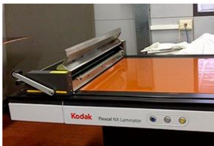
Рисунок 4.3 – Використання ламінатора для технології Flexcel NX
