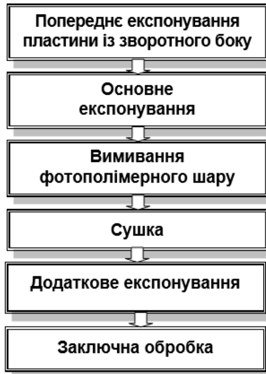
Рисунок 4.1 – Етапи виготовлення фотополімерних друкарських форм
