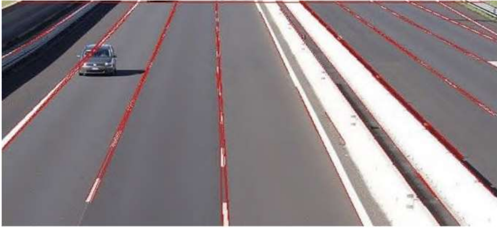
Рисунок 2.6 – Вигляд початкового зображення після виділення ліній перетворенням Хафа
