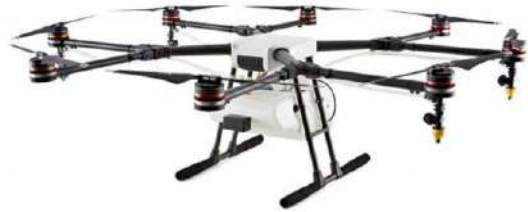
Рис. 2 – Зовнішній вигляд мультикоптера з балоном із вуглекислотою
