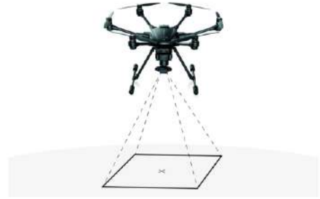
Рис. 7 – Схематичне зображення положення камери на мультикоптері
