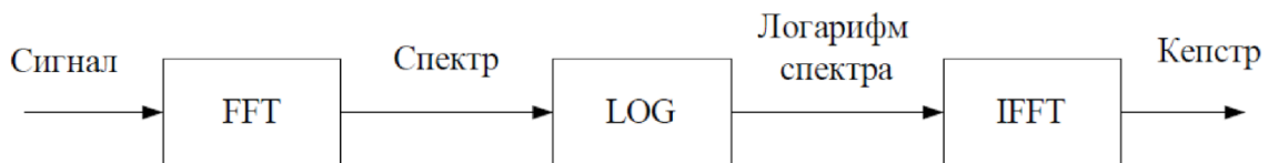
Рисунок 3.8 – Структурна схема розрахунку кепстру
