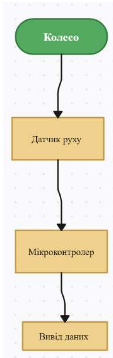
Рисунок 1.3 – Схема обробки датчика одометру
