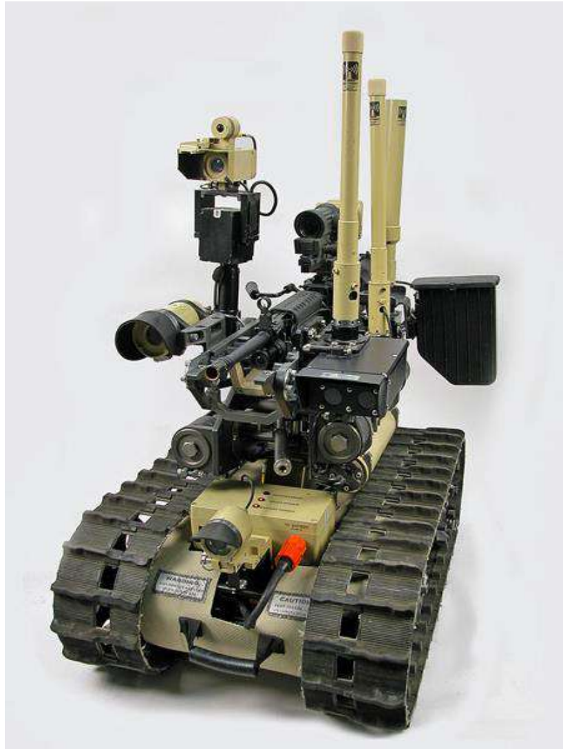
Рисунок 1.1 – Колісний робот SWORDS
